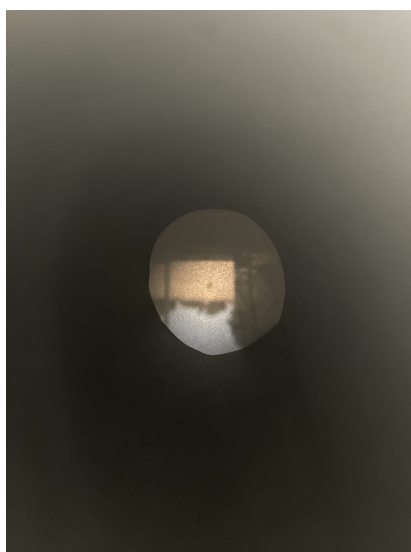
Obrázek 3: Změna vzdálenosti projekční plochy s konstantní velikostí dírký
