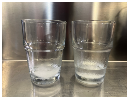
Obrázek 2: Stále tající neposolený led (vlevo) a roztátý posolený led (vpravo)
