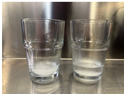
Obrázek 7: Stále tající neposolený led (vlevo) a roztátý posolený led (vpravo)
