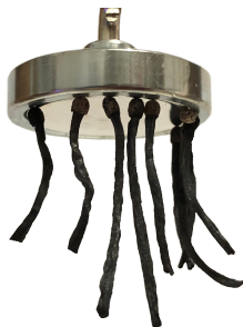
Obrázek 1: Magnetem přitahované sirky
