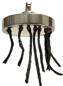
Obrázek 10: Magnetem přitahované sirky
