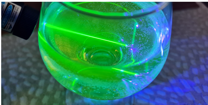
Obrázek 4: Extrémně silná fluorescence roztoku disodné soli fluoresceinu při ozáření fialovým laserem. Původní paprsek lze vidět pouze v odraženém světle. V prošlém světle lze pozorovat slabou fluorescenci textilu, ta je způsobena optickými zjasňovači v pracím prostředí.
