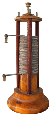
Obrázek 2: Voltov stĺp – zdroj stáleho jednosmerného napätia 3
