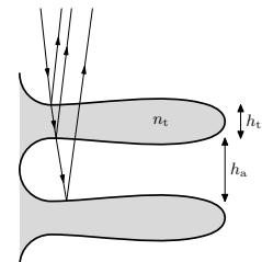
Aby došlo ku konštruktívnej interferencii, jednotlivé lúče musia mať fázový rozdiel  $\Delta\Phi = 2k\pi$ , kde  $k$  je celé číslo. Fázy určíme z optických dráh jednotlivých lúčov.
